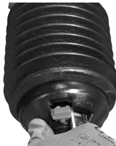
Bilde 6.1: Åpne kardangakselbeskyttelsen
